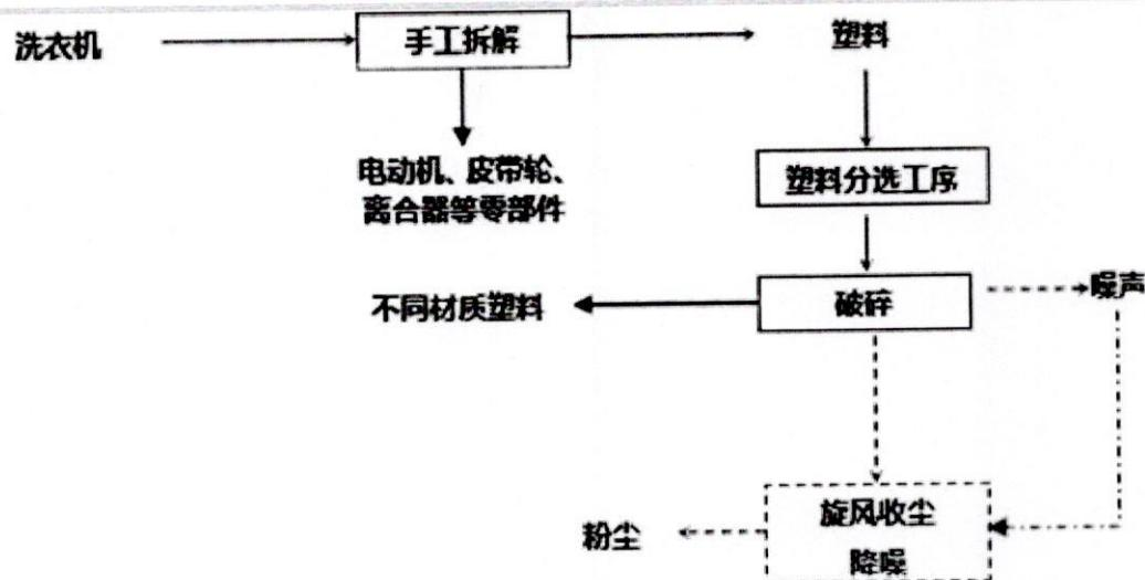
**洗衣机拆解流程图**
