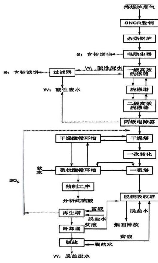
烟气制酸及脱硫系统生产工艺流程
