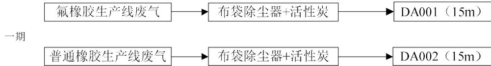
图 2-4 现有项目实际建设废气收集及处理设施汇总表
